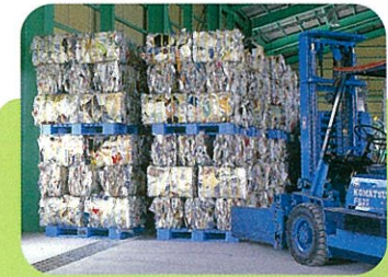
ベール 分別収集されたプラスチック類 容器包装類を梱包したもの。
